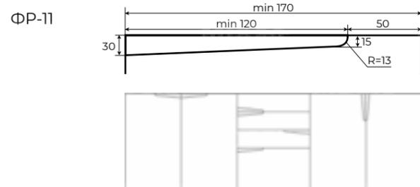
❗ Внутри интегрированной ручки допускается неровности в виде шагрени, обусловленные внутренней структурой МДФ.
