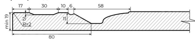
\*Данный минимум толщины фасада предназначен для максимальной глубины присадки 13,5 мм.
